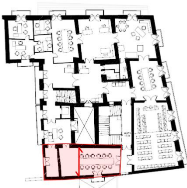
Ilustración 5 Zona afectada por asentamientos diferenciales
